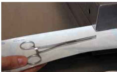
Klarsichtfolien/Papier-Verpackung erhält eine Siegelnaht
